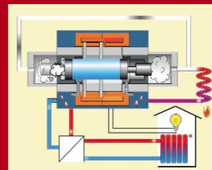
Die beim Prozeß anfallende Abwärme wird über einen Wärmetauscher dem Heizkreislauf und der Warmwasserversorgung zugeführt. Und dabei schnurrt Ihr *lion* nur wie ein zufriedenes Löwenbaby.
